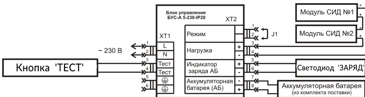
Схема соединения БУС-А 5-230-IP20 арт. 21/23 с нагрузкой, состоящей из модулей со СИД (2\*МС 2,5-160-0 DC).
